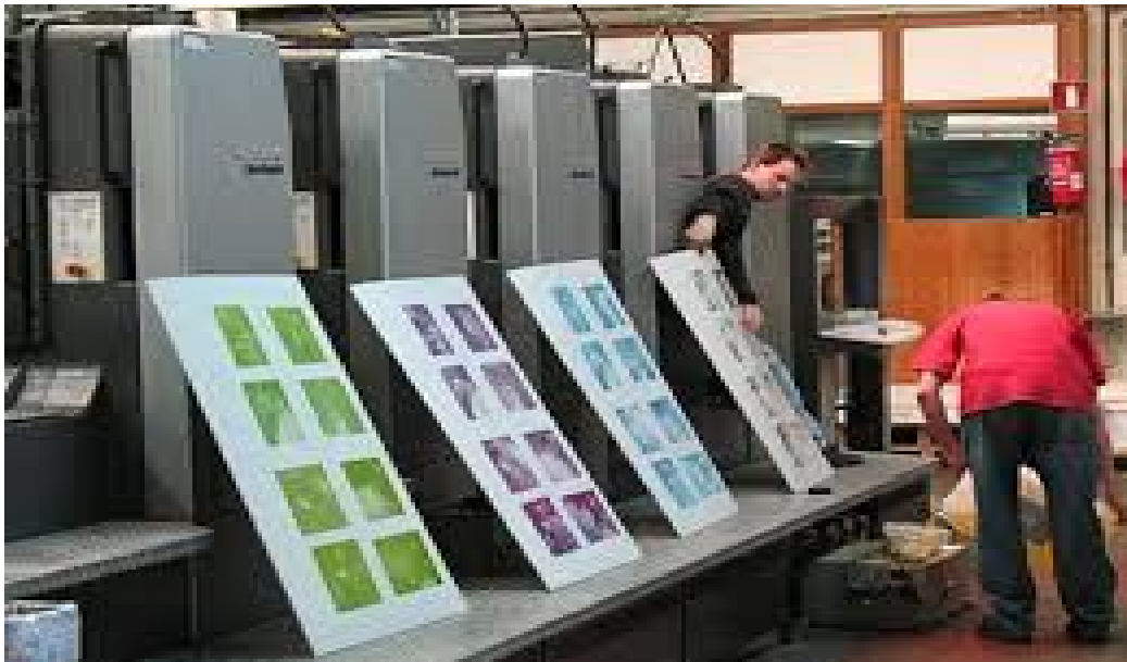
شكل رقم (33) صورة توضح كيفية ترتيب البليتات قبل تركيبها على الماكينة بعد عملية الفرز بحيث يثبت كل لون على وحدة طباعة منفصلة
