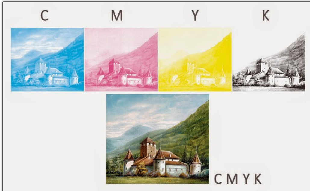
شكل رقم (35) صورة توضح وضعية الطباعة لكل لون على حدى ويوضح الكادر السفلي طباعة كل الألوان معاً
