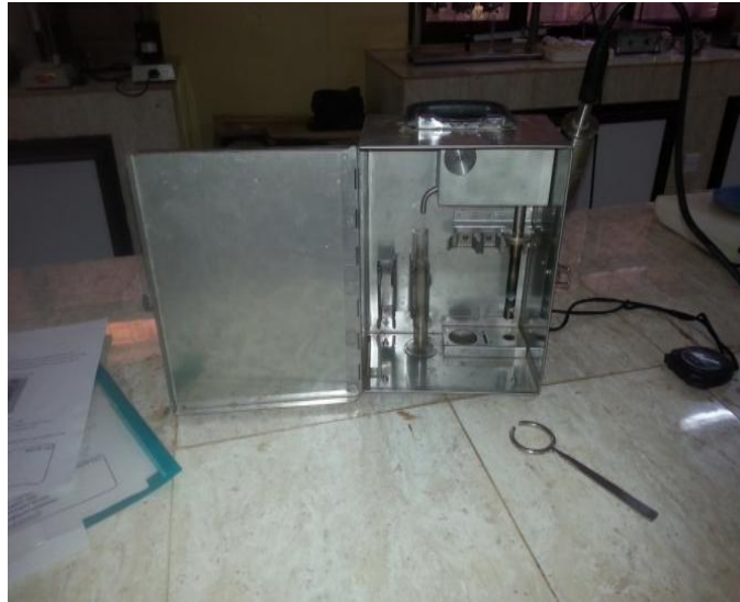
شكل رقم (6.3): جهاز قياس نسبة المواد الصلبة
