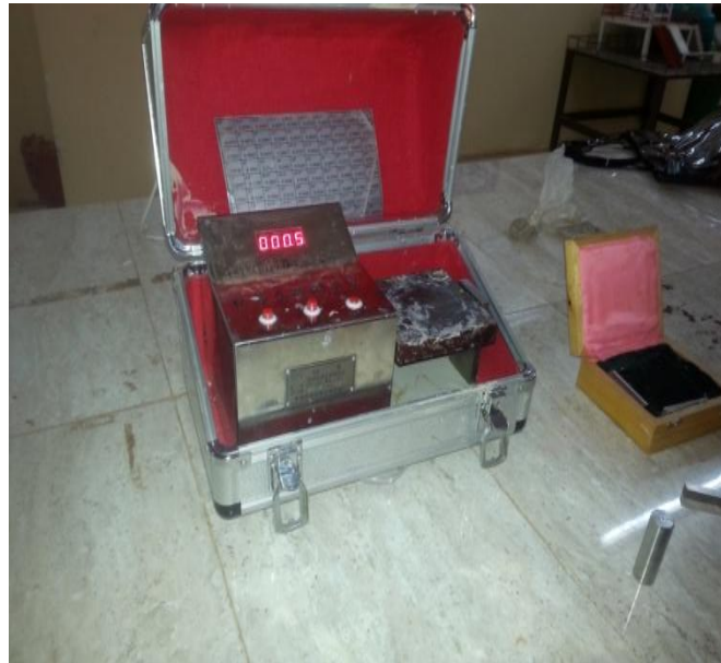
شكل رقم (8.3): جهاز قياس معامل الإحتكاك
