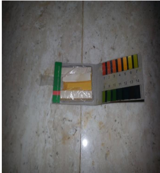
شكل رقم (5.3): أوراق قياس الحمضية والقاعدية
