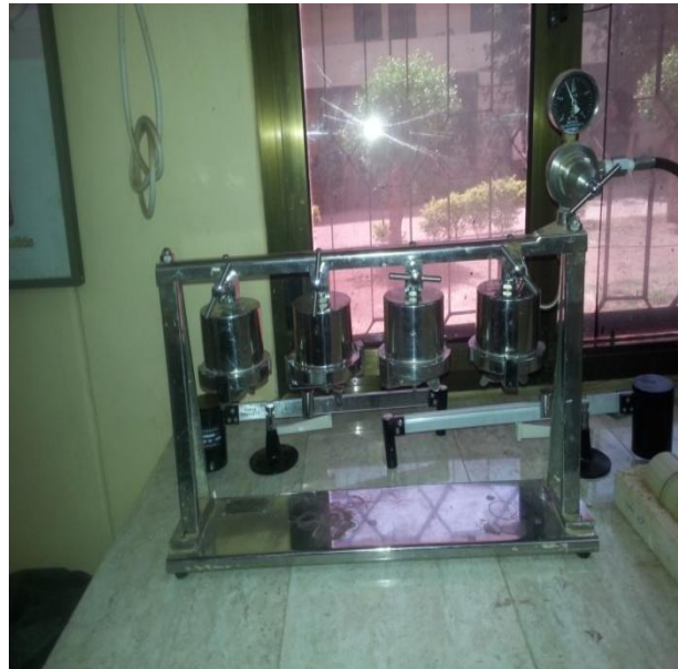
شكل رقم (7.3): جهاز قياس فاقد الرشح
