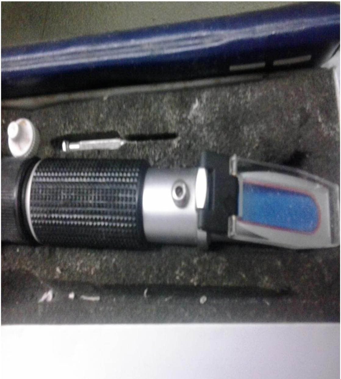
ملحق رقم (١) : جهاز Re Fractometer "منشور بالداخل وعدسه"
