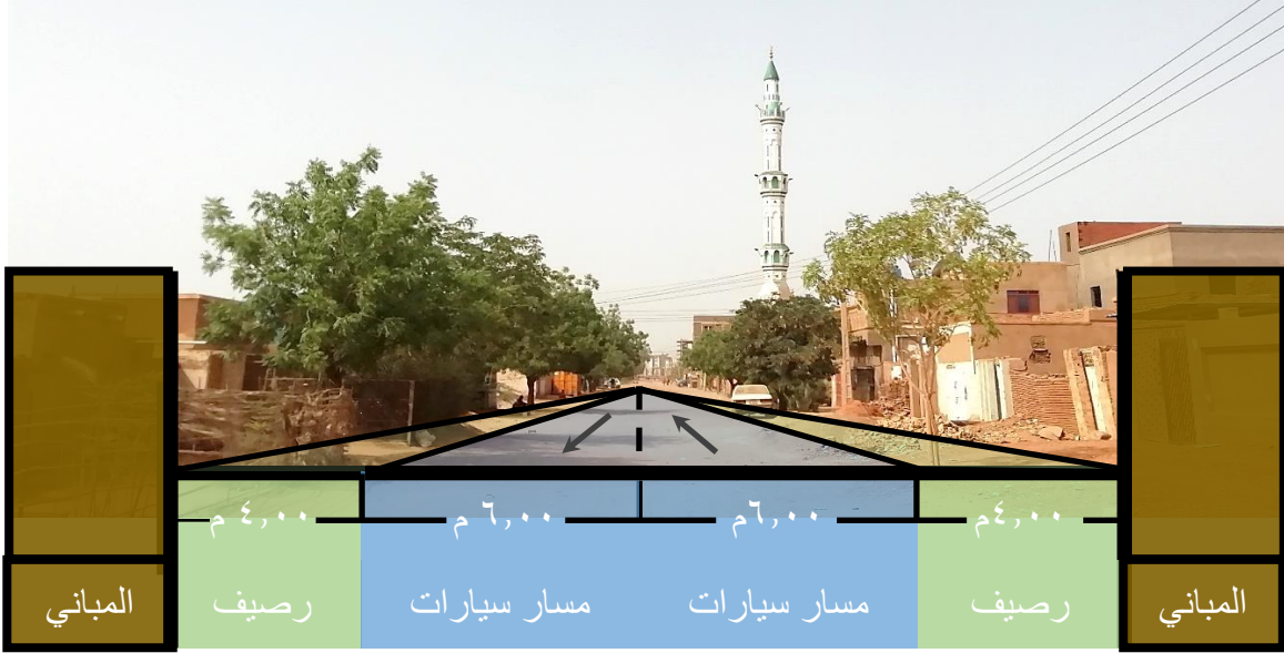
شكل ٣-١٨ قطاع عرضي بشوارع عون الشريف قاسم (المصدر: الباحثة مايو ٢٠٢٢) ٣-٥-٣ العلامات المميزة بالحي:
