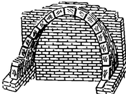
شكل(3-43): طريقة بناء القبو وارتكازه (ب)شكل يوضح طريقة بناء القبو ويظهر دوران القبو (أحمد منصور-العمارة التلقائية والتوافق البيئي)
