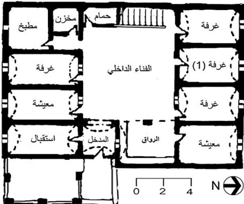
شكل(4-10) يوضح المسقط الأفقي للمسكن النوبي التقليدي(المصدر: الباحث)
