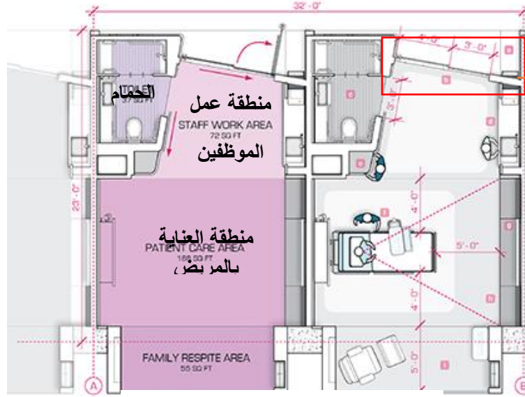
شكل رقم (3-12) توضح مسقط افقي لعنبر مفرد كاحد الحلول التصميميه
