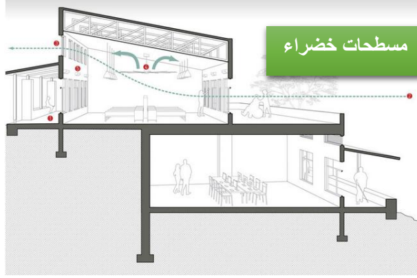
صوره (11-4) توضح قطاع راسي يوضح حركة الهواء الطبيعي
