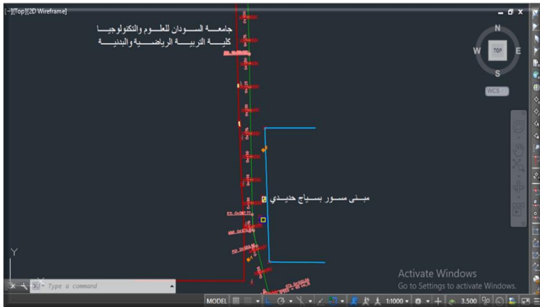
شكل (4-5) مناسيب الأرض الطبيعية لمحور الطريق
