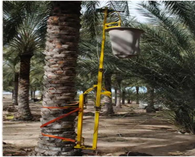
صورة (3):الألة بعد وصلها بالنخلة لحصاد التمر
