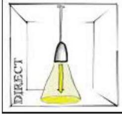
**1-5-1-2 الإضاءة المباشرة Direct Lighting :** يتم الحصول عليها بأبسط الطرق بوضع أجهزة تعطي ضوء مباشر ، وفي هذه الحالة تتركز كل الطاقة الضوئية الى الاسفل وقد تكون سقفية او جدارية ، ظاهرة سطحية او غائرة او تكون حرة قابلة للنقل والتحريك وهذا النوع يتميز بتشتيت جيد للإضاءة داخل الفضاء .
