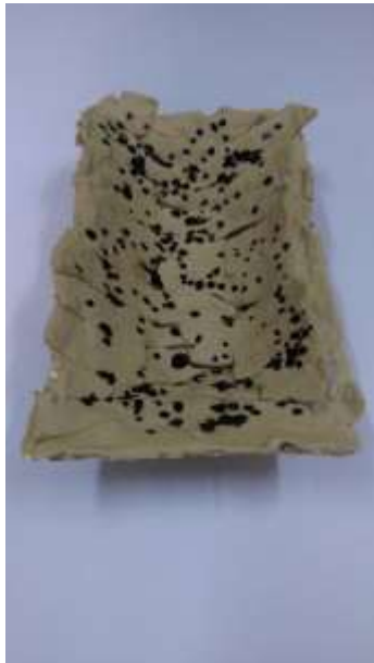
صورة رقم (14) اسطوانة من الخلطة رقم 44 تهدلت بسبب الحرارة .
