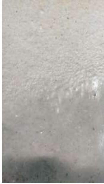
صورة رقم (12) مظهر السطح للخلطة رقم 6 بعد المعالجة الحرارية.
