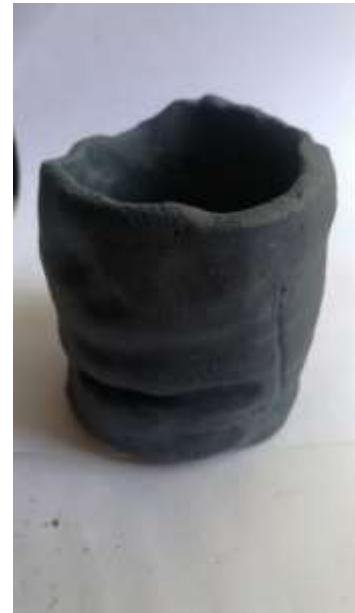
صورة رقم (13) صحن من الخلطة رقم 12 عليها خرز بعد المعالجة الحرارية .
