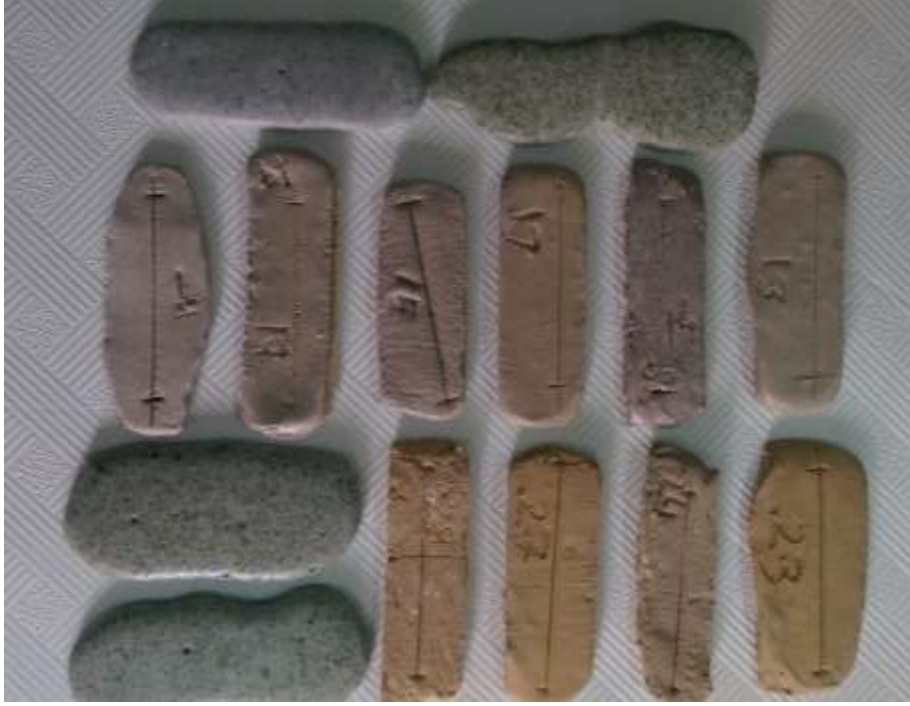
صورة رقم (3) نماذج مختلفة لشرائح تم معالجتها حرارياً .
