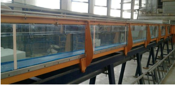
الشكل 4: القناة الزجاجية المستخدمة كحوض ترسيب مستطيل في مخبر الهيدروليك
