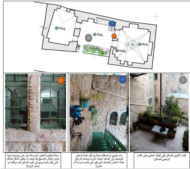
شكل رقم (5-18) يظهر أهم العناصر المضافة إلى مسكن آل الرجبي المصدر الباحثة 2020
