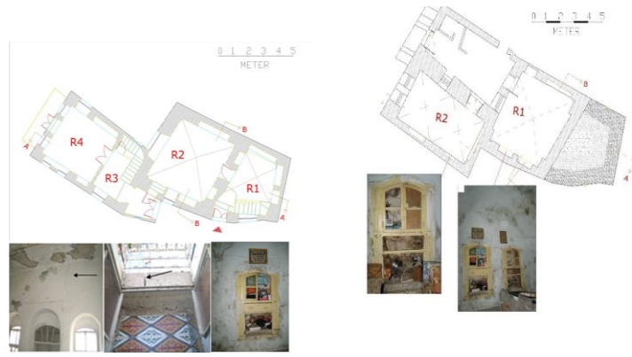
الشكل يمثل الطابق الأول لمسكن آل سياج يظهر فيه بعض التفاصيل للأرضية والخزان والاسقف
