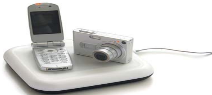
شكل (2.3) قاعدة موزع الطاقة اللاسلكية تستخدم طريقة الحث المغناطيسي المزوج لشحن عدة أجهزة في نفس الوقت
