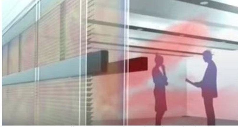
صورة (28-2) يوضح التشكيل بالنعكسية الثابتة الزجاج المزدوج والستائر اللوحية وكاسرات شمس حساسة للضوء حيث تقوم الطبقة الخارجية للزجاج بعكس الحرارة المصدر : www.google.com
