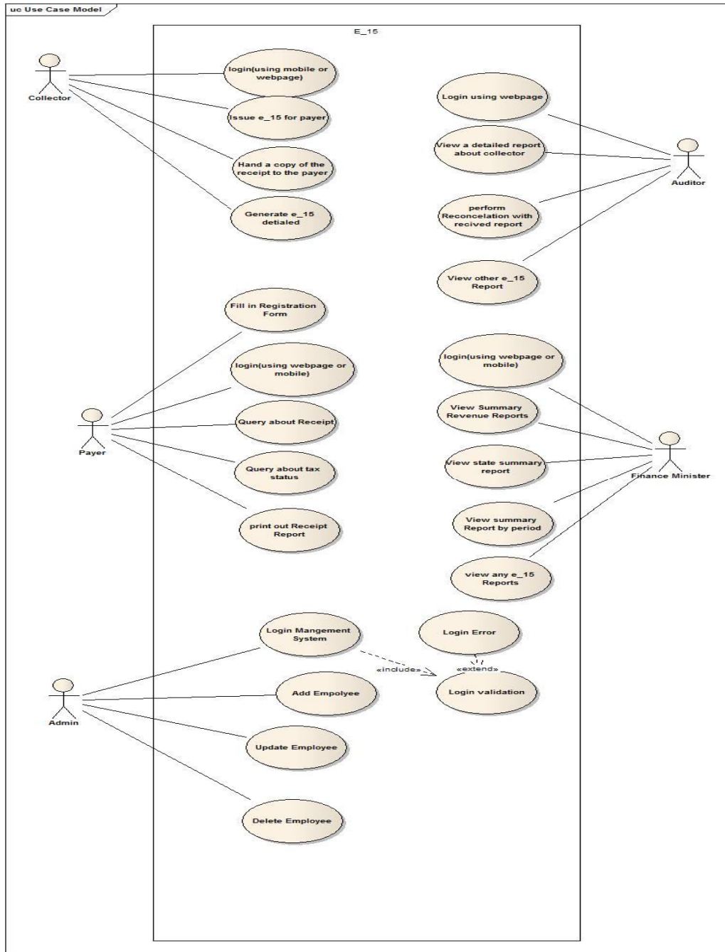
شكل 5: يوضح مخطط الحالات (Use Cases) لمستخدمي النظام المقترح
