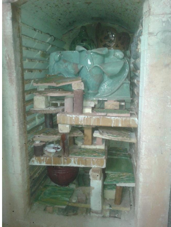
الأعمال داخل الفرن بعد الحريق الأخير
