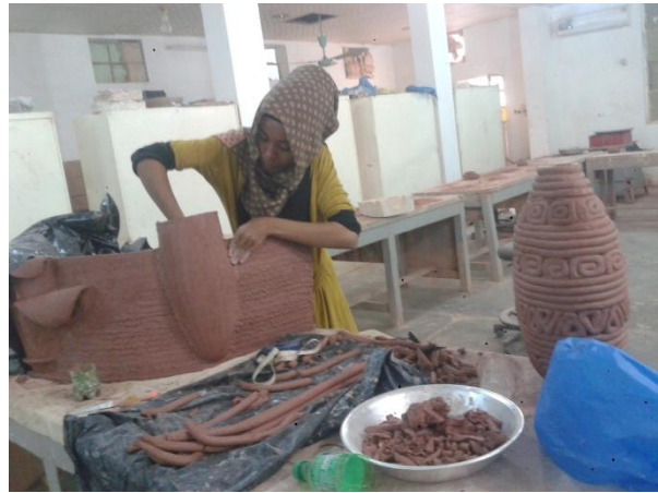
( ٣ ) تشكيل حوض النافورة بطريقة الحبال الطينية حوض النافور بطريقة المسطحات و الترقيق
