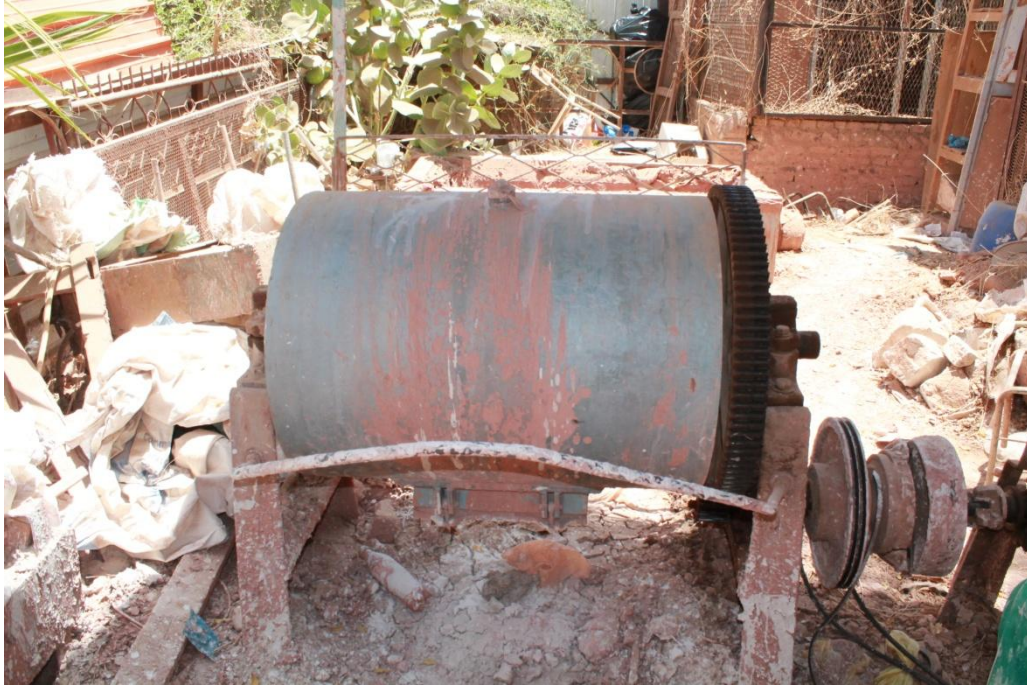
الخلاط الكهربائي المستخدم في خلط الطين
