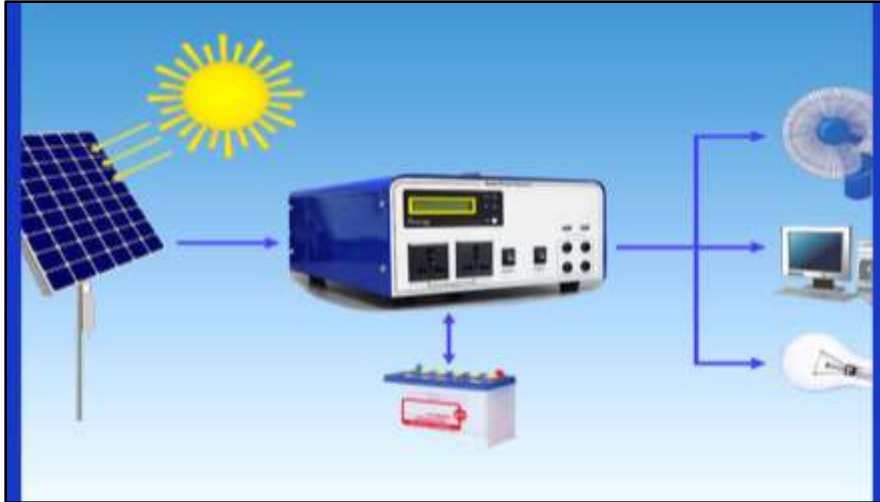
صورة (3.2) توضح توليد الطاقة الكهربائية من الطاقة الشمسية
