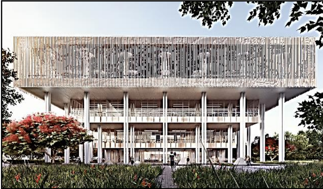
شكل (٦ -٣) استخدام البروزات و كاسرات الشمس و الألوان الفاتحة كمعالجات للحوائط
