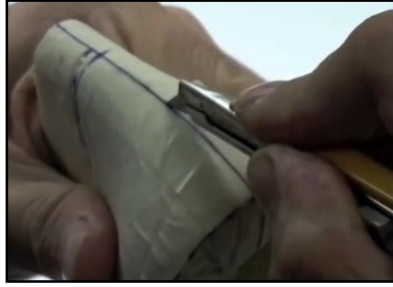
صورة رقم(76)فصل النموذج عند عقب القالب
