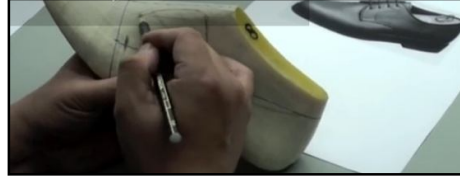
صورة رقم (58) حافة منطقة الرباط
