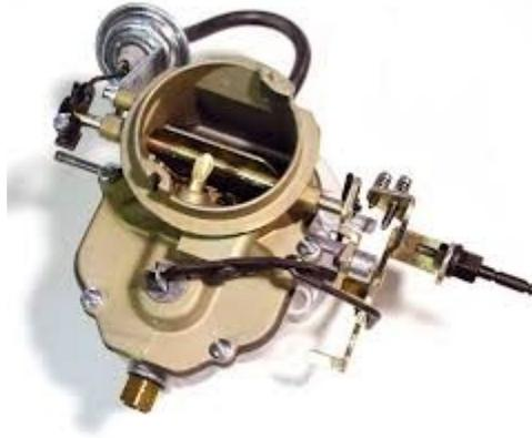
شكل رقم ( 22 ) يوضح يوضح المغذي
