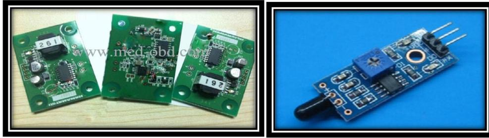
الشكل رقم (12/2) الروبوس الحساسه ( الكاشفه ) للإشعاع للإنذار عن الحريق
