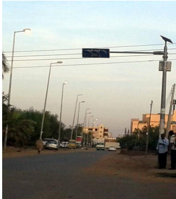
شكل رقم (3-99) إشارة مرور تعمل بنظام الخلايا الشمسية وبها كمره مربوطة بالرقابة الإلكترونية.
